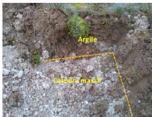
Photographies des sondages réalisés – Extrait note de présentation SOLVEO
